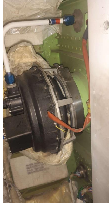
Figure 2 – IMAGE PRÉSENTANT LE MATELAS ISOLANT COINCÉ DANS LA SOUPAPE. À NOTER QU'IL FAUT VEILLER À LA POSE ADÉQUATE DU MATELAS POUR ÉVITER CE PROBLÈME.
