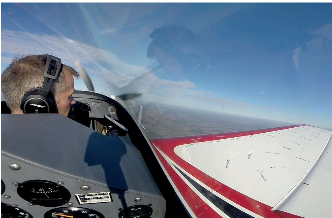
Samolot Extra300L podczas obrazowania opływu przeciągającego się skrzydła.
